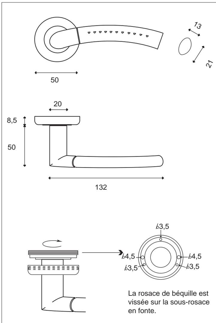
Poignée sur rosace ronde avec ressort de rappel et sous construction en fonte.
