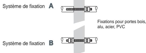
**MONTAGE SIMPLE TRAVERSANT** système de fixation traversante, indiqué par les lettres ST dans nos références
