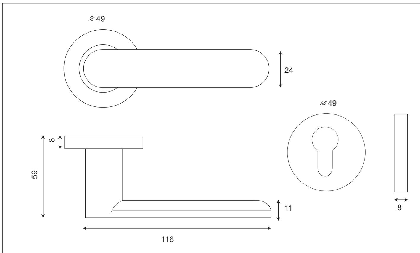
Poignée de porte arrondie sur l'arrière, avec ressort de rappel, sur rosace ronde clipsée sur sous-construction en nylon.
