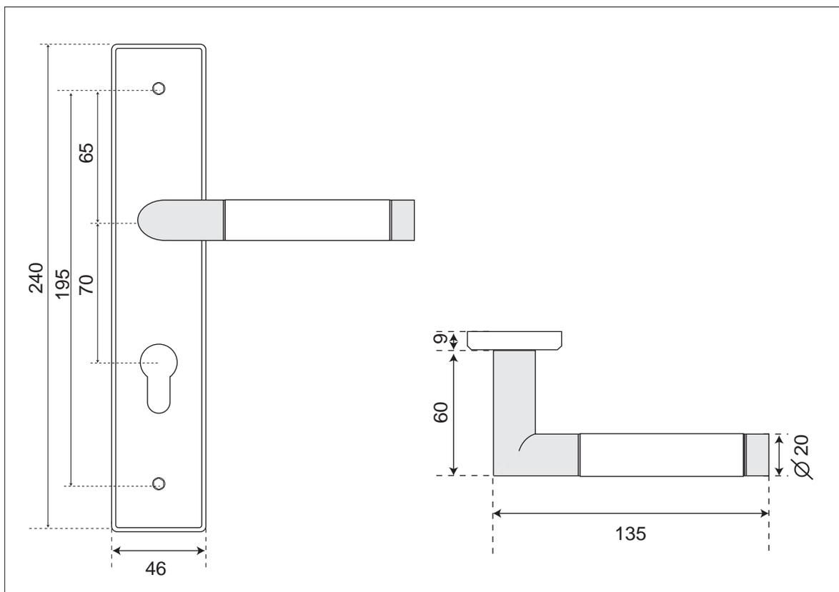
Poignée tubulaire bicolore avec ressort de rappel, sur plaque bicolore biseautée en fonte massive de 2mm d'épaisseur qui assure la solidité du modèle, renforcée par les vis de 5mm tête 6 pans non visibles pour garantir la sécurité extérieure carré de 7mm, pour portes de 40 à 65mm (à spécifier)
